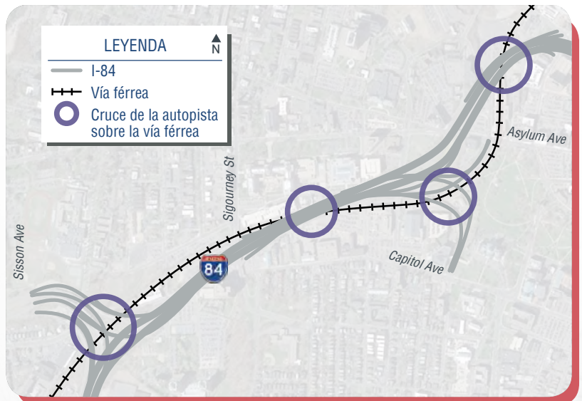
La I-84 y la vía férrea están entrelazadas en toda el área de estudio. La carretera “fue cuidadosamente diseñada para preservar la vía férrea”, según el Estudio ambiental y de uso compartido de la I-84 (1970) .
